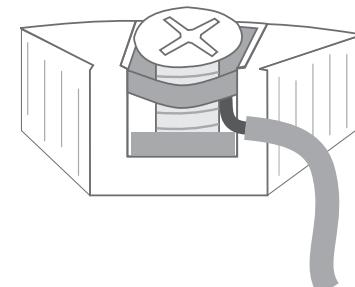
Les fils doivent être montés entre les plaques métalliques.
