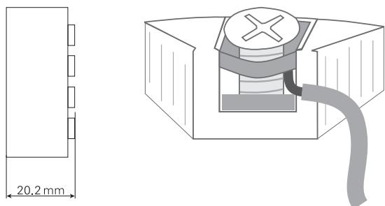
Die Leitungen müssen zwischen den Metallplatten montiert werden.
