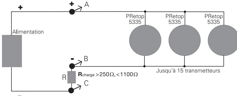
Pour la communication digitale HART® de 2-fils, les sorties de 15 transmetteurs au maximum peuvent être connectés en parallèle.
